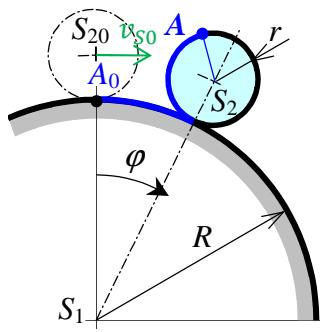
Válec o středu  $S_2$  se valí po pevném válcu o středu  $S_1$ .
