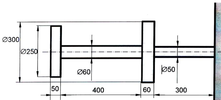
**Dáno:** budící silová dvojice  $M_1(t) = M_0 \cdot \sin \omega t$ ,  $M_0 = 5 \text{ Nm}$ ,  $\omega = 1300 \text{ s}^{-1}$ ;
