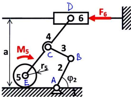
Určete pohyblivost a statickou určitost soustavy, uvolněte jednotlivá tělesa a sestavte rovnovážné rovnice v poloze popsané úhlem  $\varphi_2$ . Uvažujte vliv tíhy na všech tělesech a odvalování tělesa 5.
