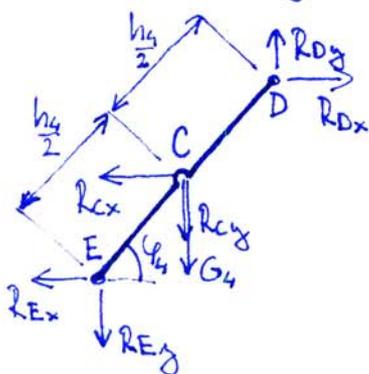
$$x: R_{Dx} - R_{Cx} - R_{Ex} = 0$$
