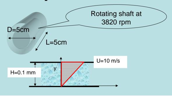
Gap width H=0.1mm, U=10 m/s, oil M9ADS-II at  $0^{\circ}$ C  $\mu$ =3.4 Pa.s,  $\gamma$ =10<sup>5</sup> 1/s,  $\tau$ =3.4.10<sup>5</sup> Pa,  $\tau\gamma$ = 3.4.10<sup>10</sup> W/m<sup>3</sup>
