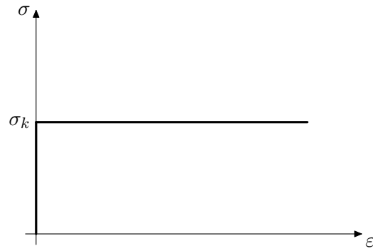
OBRÁZEK 2. Závislost napětí a deformace pro St. Venantovu látku
