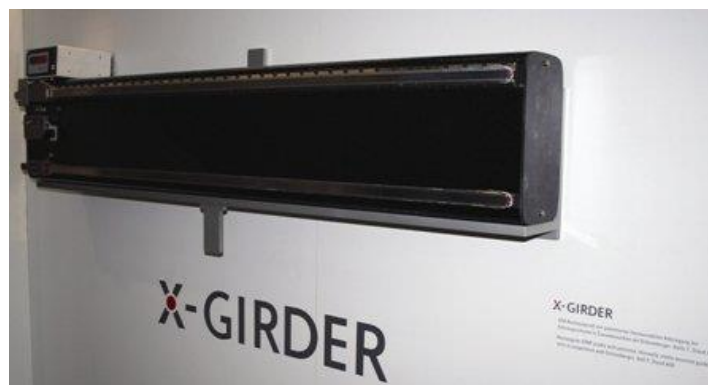
Obr. 2: Nosná část obráběcího stroje vyrobená z vláknového kompozitu [8]
