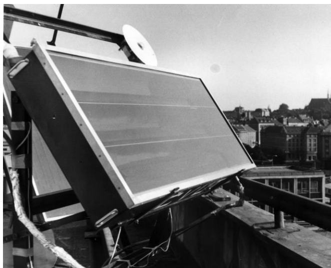
Obr. 10 Geometrické poměry parabolických zrcadel a lamely absorběru v koncentrujícím kolektoru ČVUT – TŽP a jeho prototyp při zkoušce na Katedře techniky prostředí
