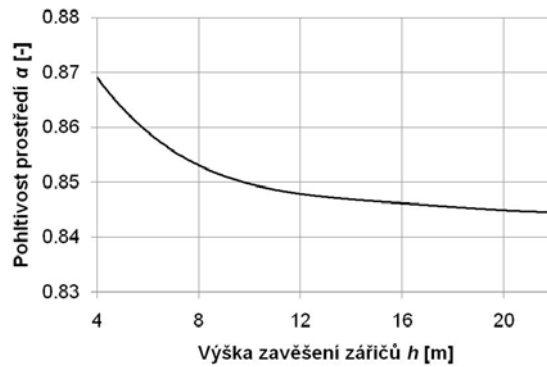
Obr. 112 Závislost pohltivosti prostředí \alpha na výšce zavěšení zářičů h
