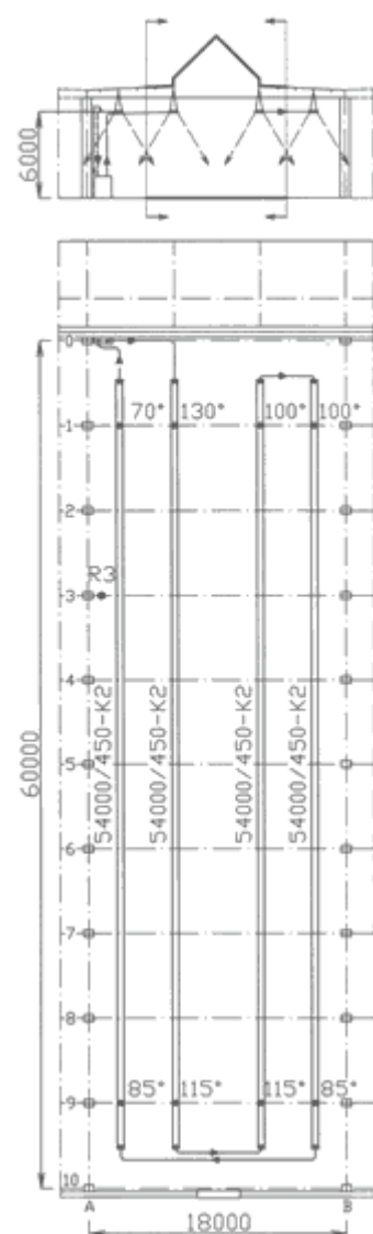
Obr. 87 Vnitřní lod'. Správné zapojení sálavých pásů ve vnitřní lodi při velkém teplotním rozdílu teplotnosné látky (130/70°C)
