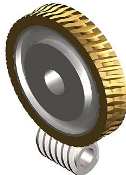
šnekové soukolí válcový šnek a globoidní kolo
