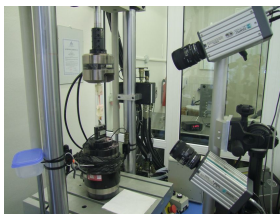
Trhací stroj MTS MiniBionix kombinovaný s 3D digitálním korelátorem pro analýzu deformací
