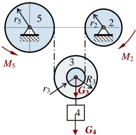
Principem virtuálních výkonů vypočítejte velikosti potřebných hnacích silových dvojic  $\mathbf{M}_2$  a  $\mathbf{M}_5$  pro statickou rovnováhu mechanismu.
