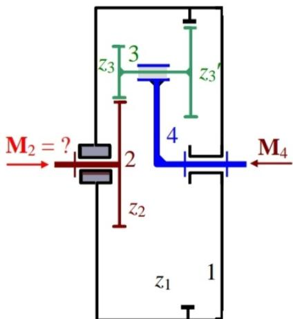
Hřídel 4 planetové převodovky podle obrázku je zatízen silovou dvojicí o momentu  $\mathbf{M}_4$ . Principem virtuálních výkonů vypočítejte potřebný moment  $\mathbf{M}_2$  silové dvojice působící na člen 2 pro statickou rovnováhu mechanismu.
